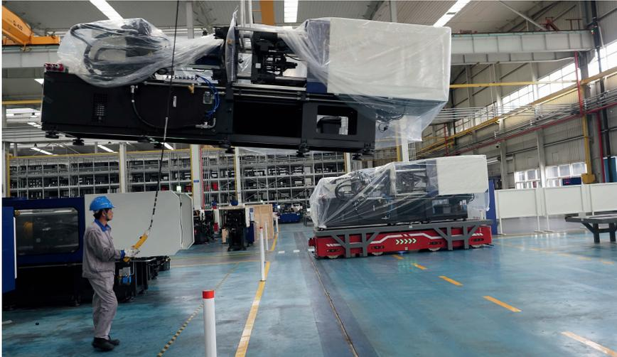
Smart Factory: Von der Fließfertigung fahren die fertigen Maschinen direkt in den Logistikbereich. Die Anlage am Haken im Vordergrund wird in wenigen Sekunden auf einem Lkw abgestellt. © Hanser/Schröder
